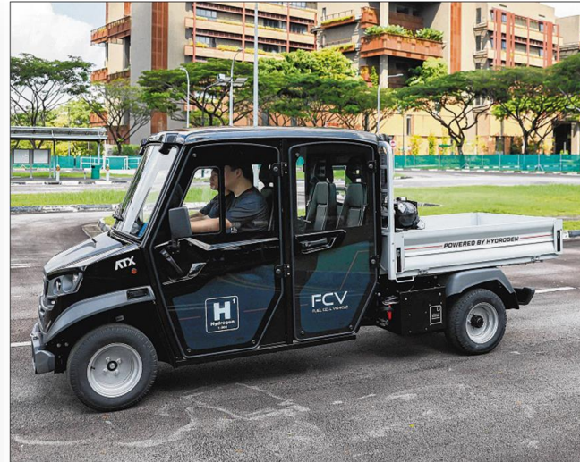
GUNA TENAGA HIDROGEN: Lori diubah Spectronik bernama "Cruiser" ini menggunakan sel hidrogen sebagai bekalan tenaganya. - Foto JTC
